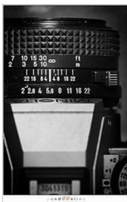
Figuur 4: Diafragma ring met de hele diafragmawaarden op een oude Minolta 50mm 1:2
