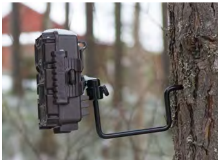
▲ De Bushnell Trophy Cam HD wordt met een handige schroefhaak met een balhoofdje aan een boom bevestigd.
